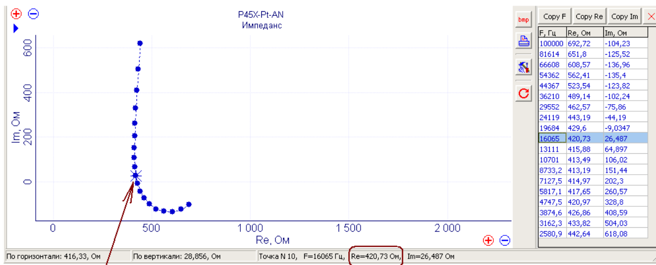
Рис. 5. Определение омического сопротивления по спектру импеданса. Режим обработки ES8, красной стрелкой указана точка, по которой нужно определять величину омического сопротивления. Если кликнуть по ней, то снизу будут выведены ее координаты (значение омического сопротивления обведено). Пример достаточно низкого сопротивления (с проходом годографа через действительную - горизонтальную ось).
