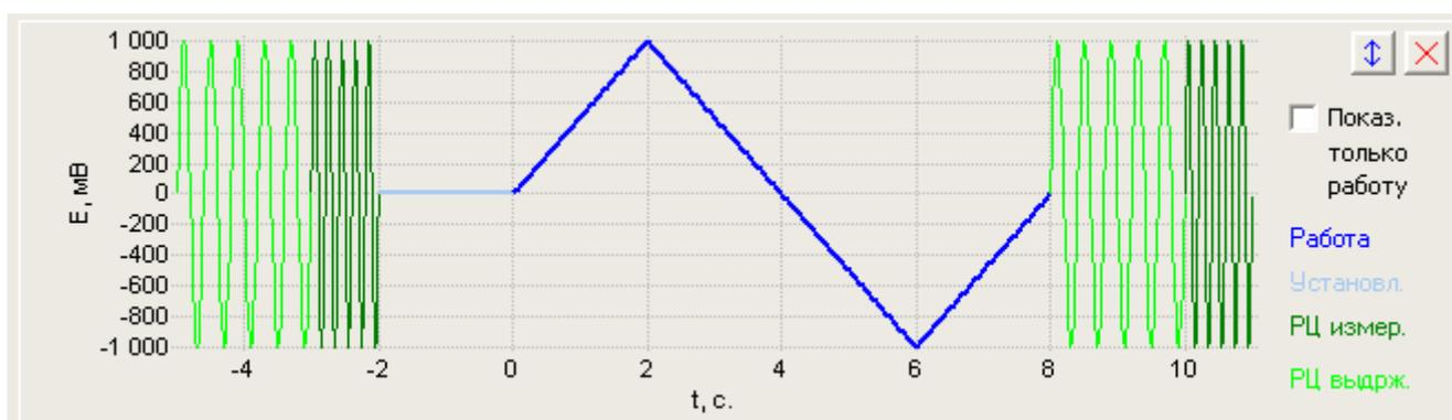
Диаграмма прогноза (в частности, приведенный здесь рисунок) наглядно демонстрирует – какие рабочие этапы (стадии) имеются у каждого единичного режима (они будут последовательно выполнены друг за другом, если были включены пользователем в панели настроек запуска и завершения единичного режима):
