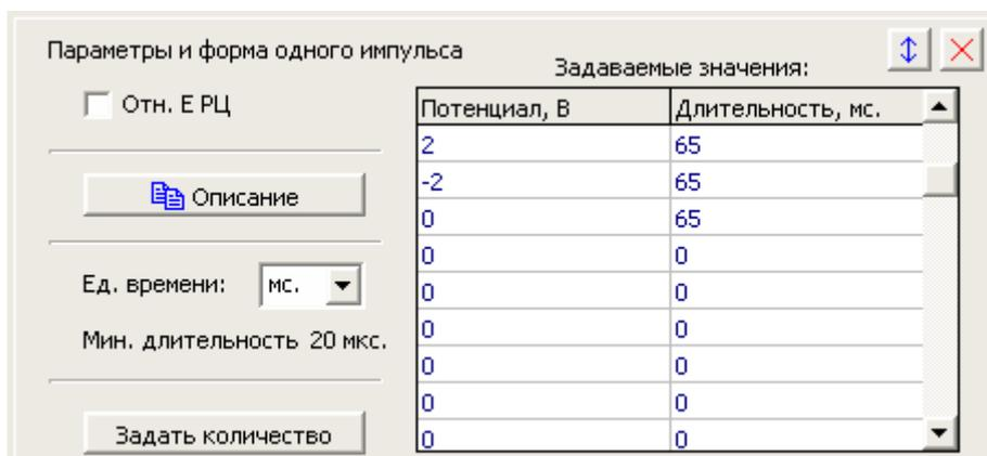
Этот режим создан для того, чтобы можно было создавать самые необычные рабочие программы импульсных режимов. Также его можно считать более медленным вариантом произвольного хроно режима при временах (длительностях импульсов – их ступеней и отдельных амплитуд) от десятков микросекунд до десятков миллисекунд.
