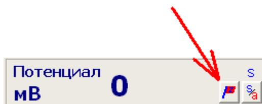
При нажатии на эту кнопку появится окно со списком сообщений о работе модуля частотного анализатора (эта кнопка исчезнет, а список сообщений очистится сразу после запуска нового эксперимента):
