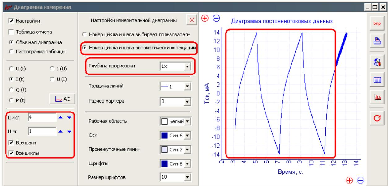
Диаграмма во время работы. Номера циклов автоматически переключаются к текущему (поэтому последний цикл выделен). **Большая** глубина прорисовки данных. Как видите, в конкретно этом эксперименте глубины прорисовки 4x с запасом хватило на отображение всех, имеющихся на настоящий момент экспериментальных циклов:
