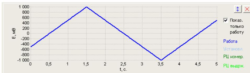
5 проходов дают два с небольшим периодов циклической развертки:
