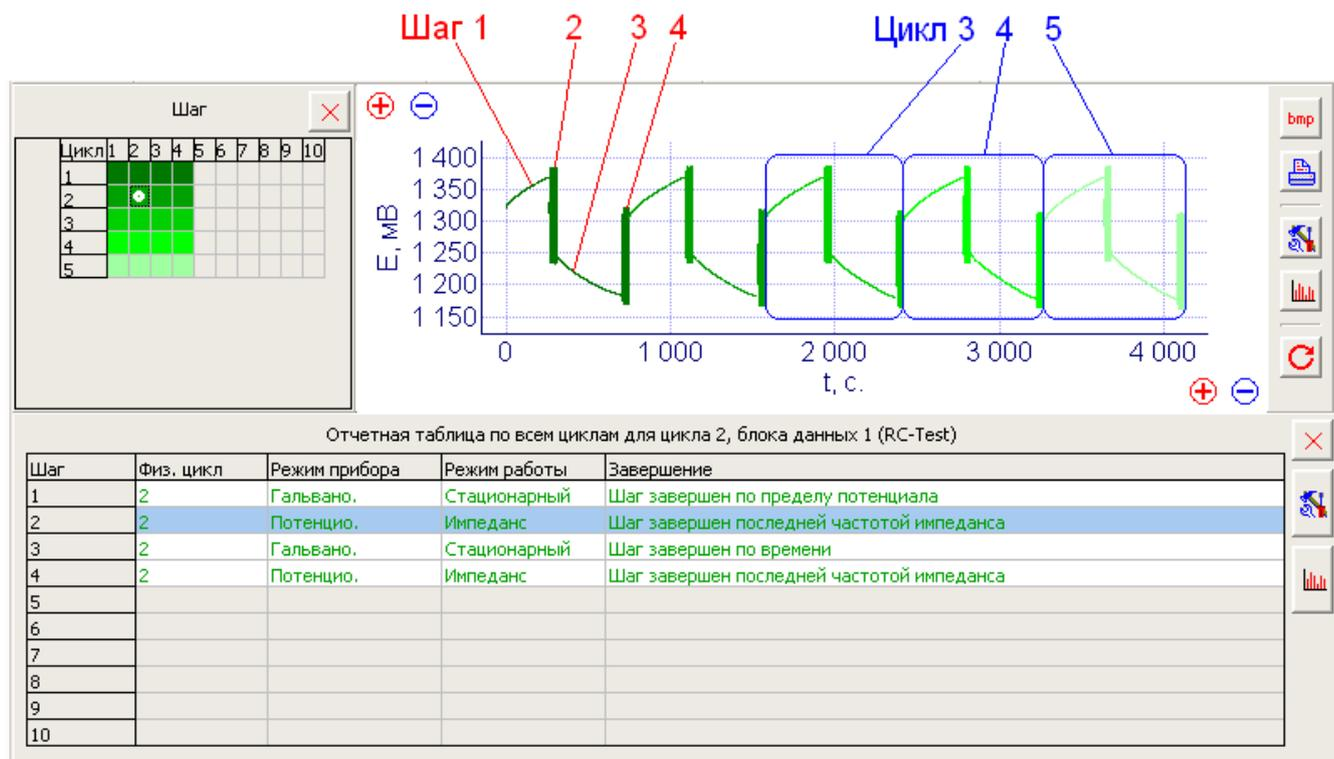
В приведенном примере использовано 5 однотипных циклов, в каждом из которых имеется 4 различных шага. Циклы отображены зеленым цветом от темного к светлому при переходе от первого к пятому. Обратите внимание на таблицу внизу для расшифровки каждого шага второго цикла (можно выбрать любой другой цикл из имеющихся). А также на графическую таблицу слева вверху – в ней наглядно двумерно отображены все имеющиеся шаги (по горизонтали) и циклы данных (по вертикали). Шаги с 5 по 10 не используются.
