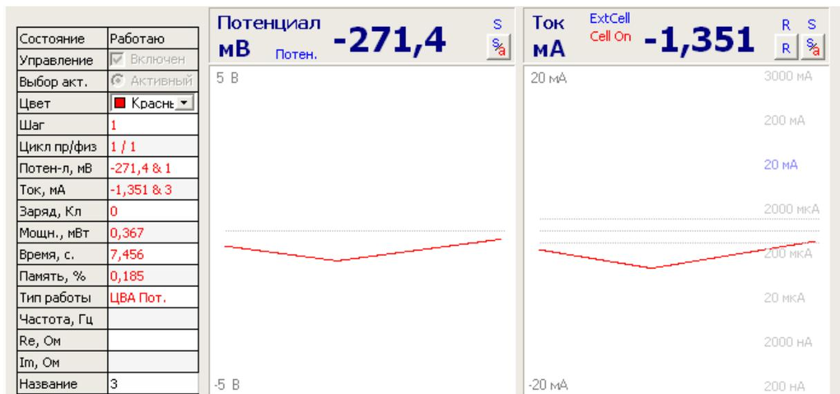
Отображение данных одного канала очень информативно и наглядно. Как и в многоканальном режиме, отображается колонка со всеми основными параметрами, а также имеются две осциллограммы - для тока и потенциала, от времени. Эти осциллограммы отображаются в масштабе текущего диапазона тока и потенциала прибора, например, как на приведенном рисунке 5 В по потенциалу, и 20 мА по току.
