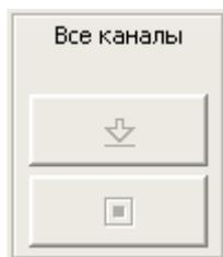
В этой панели в верхней части будут выведены номера всех включенных каналов потенциостата, то есть тех, с которыми произойдут действия, если нажать какую либо из кнопок в этой панели.
