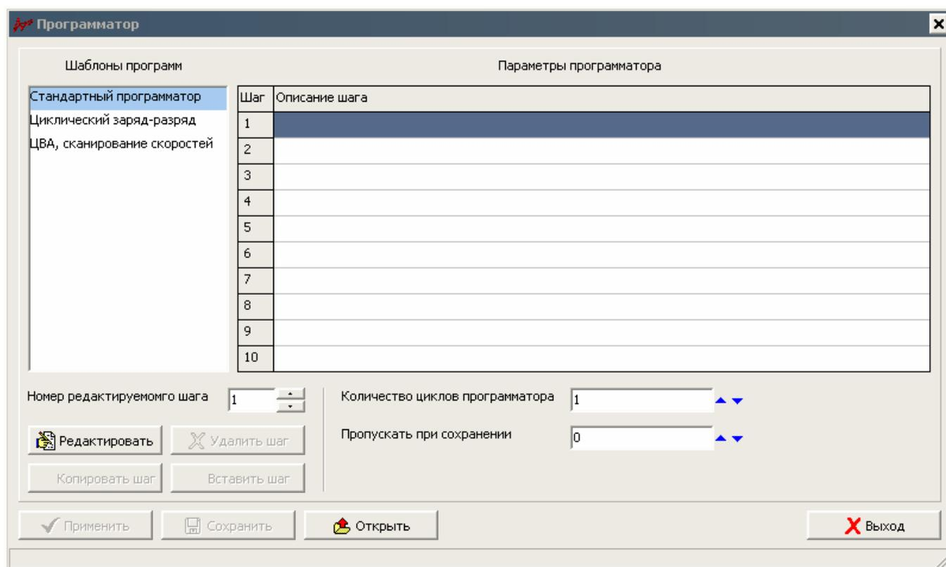
В нем слева находятся типовые простые шаблоны для быстрого создания рабочей программы. Правее – таблица с шагами программатора, а ниже – кнопки оперирования шагами программатора.
