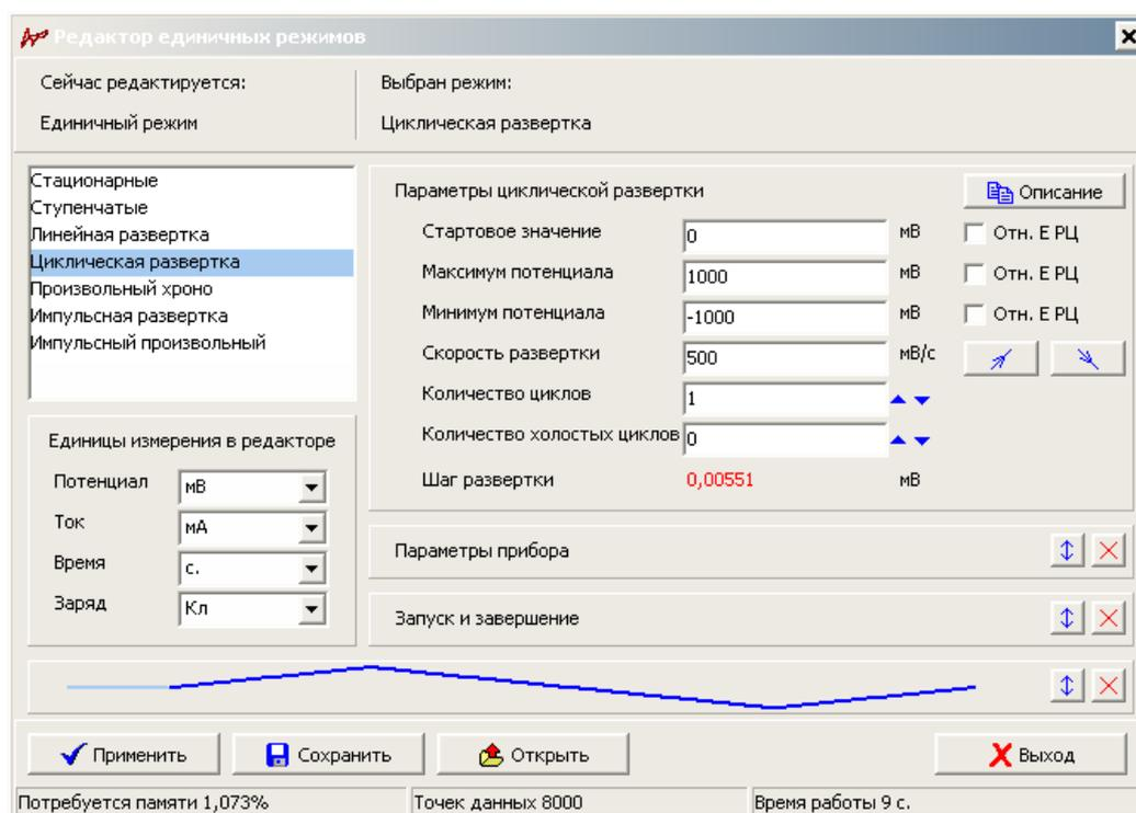
Параметры каждого из рабочих режимов состоят из основных (индивидуальных) параметров (единственная раскрытая панель на приведенном рисунке с параметрами циклической развертки в качестве примера), а также из параметров прибора и настроек запуска и завершения. Подробно индивидуальные параметры каждого из рабочих режимов описаны в соответствующих разделах. Здесь же описаны общие свойства всех единичных режимов.
