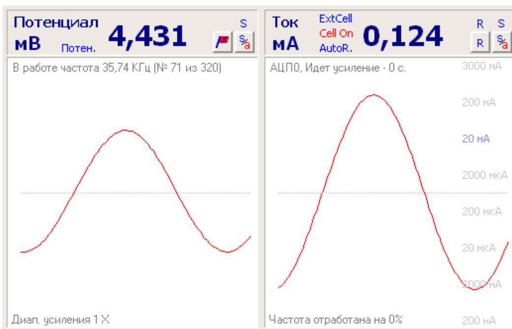
Переключение происходит при нажатии кнопки "AC" в окне измерительной диаграммы в панели выбора типа диаграммы (при этом на диаграмме станут доступны оси, соответствующие данным импеданса, измерительная диаграмма перейдет в режим отображения данных импеданса):
