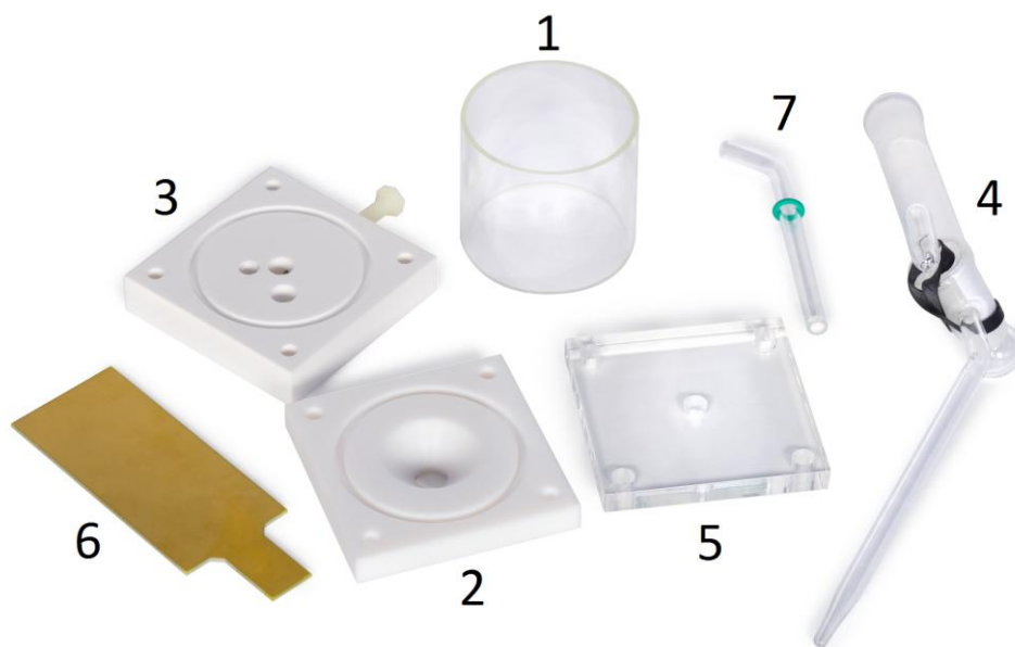
Рис. 1. Внешний вид основных компонентов ячейки по отдельности в разобранном виде. 1 – стеклянная трубка для формирования рабочей емкости; 2 – фторопластовое основание; 3 – фторопластовая крышка; 4 – мостик электрода сравнения; 5 – лифт прижима образца из оргстекла (показан со снятым прижимным винтом); 6 – токосъемник рабочего образца; 7 – продувка (может быть использована для установки проволочного вспомогательного электрода, не входящего в комплектацию).
