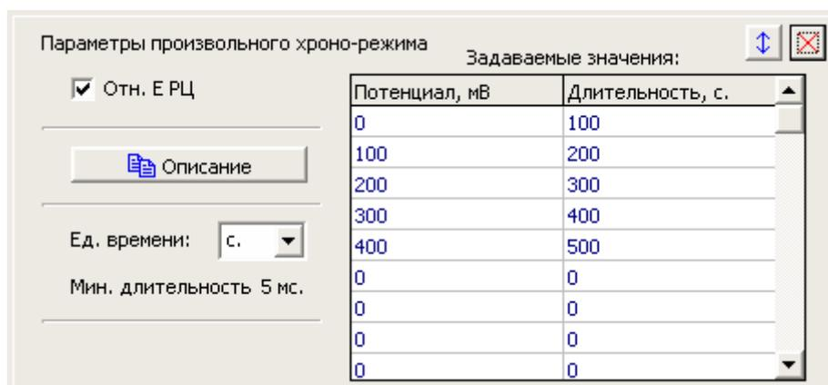
Этот режим с необычным названием создан для того, чтобы можно было создавать самые необычные рабочие программы. Также его можно считать разновидностью импульсного метода, если речь идет о временах (длительностях импульсов – их ступеней и отдельных амплитуд) от сотен миллисекунд до тысяч секунд. Для более коротких времен используется импульсный произвольный режим (он очень похож на этот режим, разница лишь в рабочих временах).
