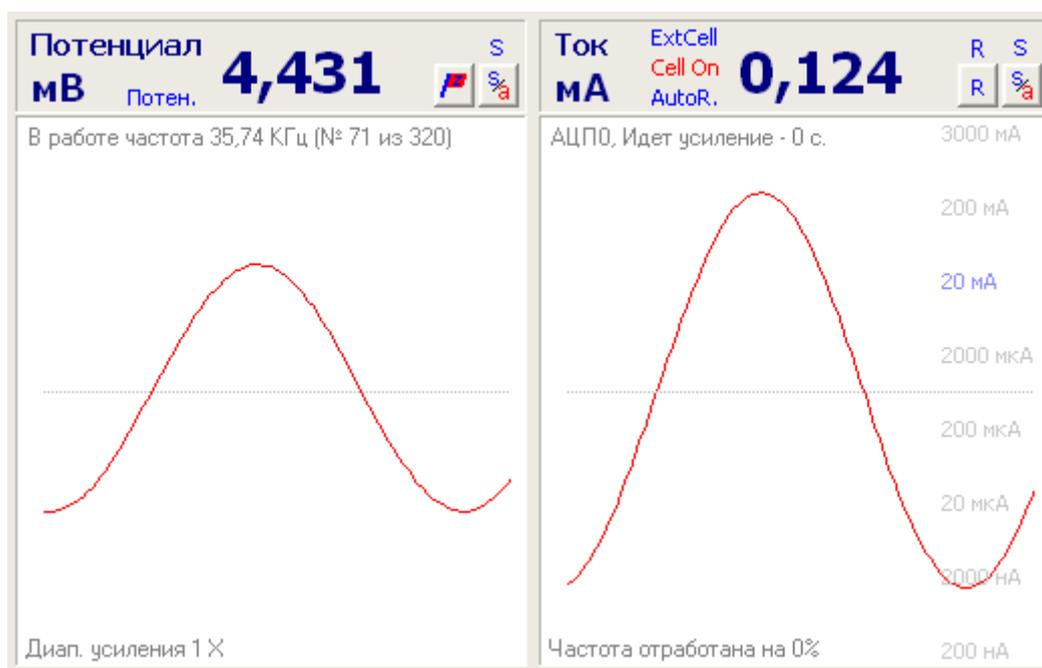
Переключение происходит при нажатии кнопки "АС" в окне измерительной диаграммы в панели выбора типа диаграммы (при этом на диаграмме станут доступны оси, соответствующие данным импеданса, измерительная диаграмма перейдет в режим отображения данных импеданса):
