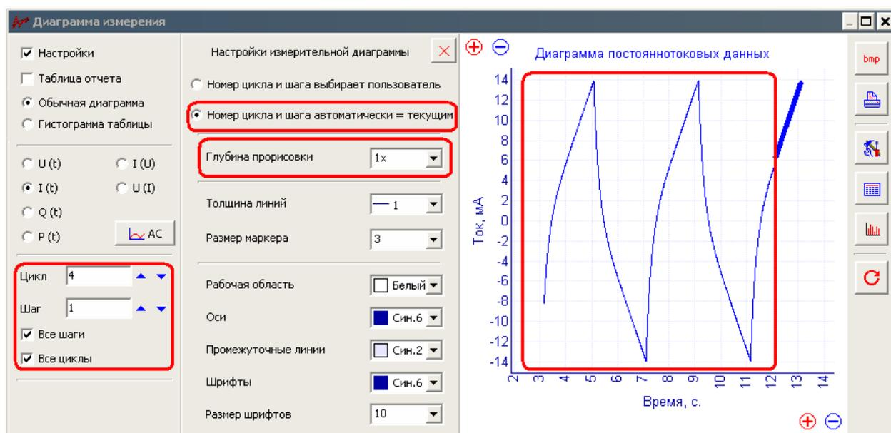
Диаграмма во время работы. Номера циклов автоматически переключаются к текущему (поэтому последний цикл выделен). **Большая** глубина прорисовки данных. Как видите, в конкретно этом эксперименте глубины прорисовки 4x с запасом хватило на отображение всех, имеющихся на настоящий момент экспериментальных циклов:
