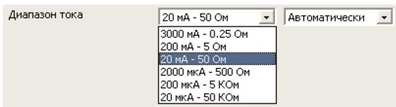
При измерении импеданса потенциостат подбирает диапазоны тока (а в этом режиме они есть еще и диапазоны измеряемого импеданса) не только по постоянному току, но и по величине измеряемого импеданса. Также микропроцессор прибора при этом анализирует амплитуды переменных сигналов, их зашумленности и много других параметров. Фактически, прибор старается выбирать диапазон тока, чтобы максимально качественно (по возможности) зарегистрировать импедансный спектр.
