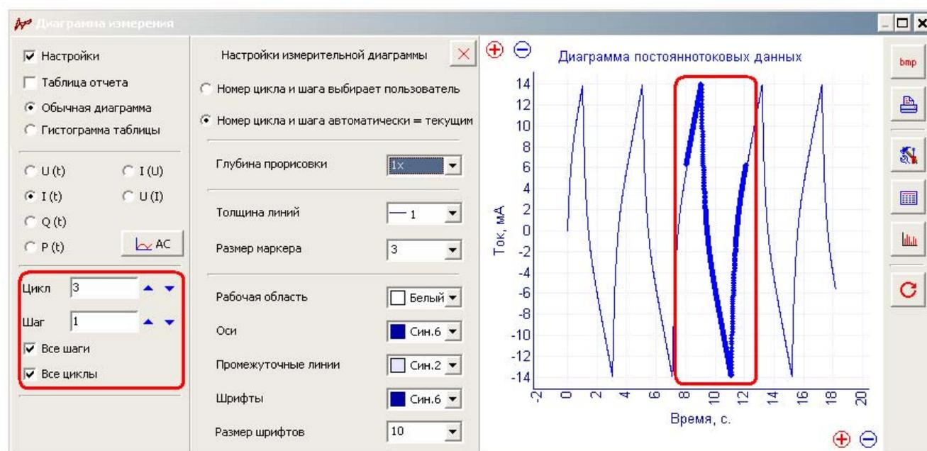
Диаграмма во время работы. Номера циклов автоматически переключаются к текущему (поэтому последний цикл выделен). **Малая** глубина прорисовки данных. Как видите, в конкретно этом эксперименте глубины прорисовки 1x хватило на 2 с небольшим цикла данных, предшествующих текущему (на самый конец первого и целиком на второй и третий. Начало первого уже не отображается):
