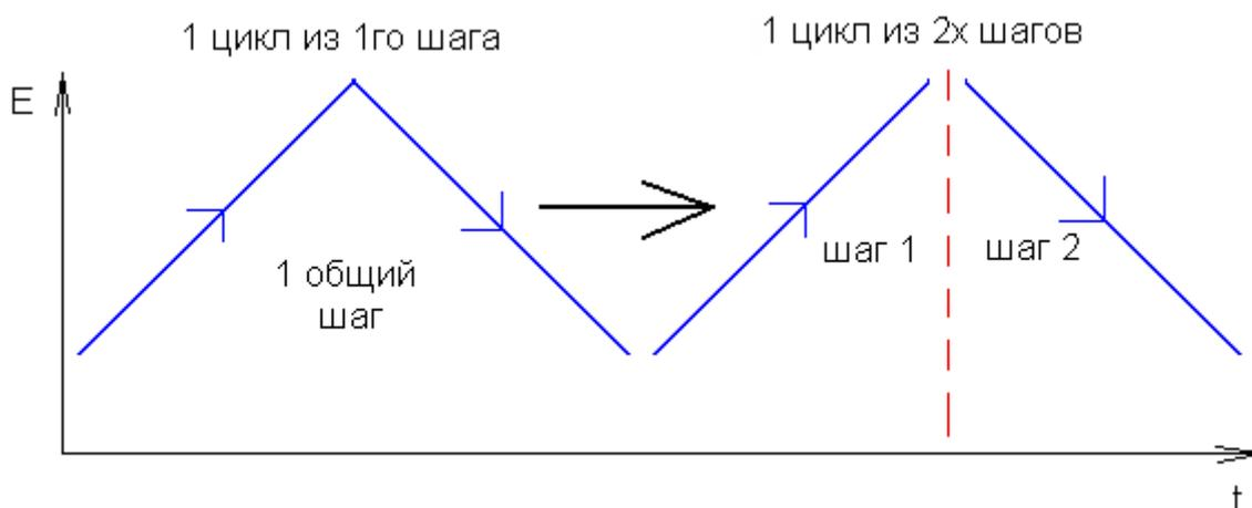
*Рис.9. Разбиение одного цикла ЦВА на два шага из линейных разверток для отдельного расчета программой прошедшего заряда для каждой из них.*
