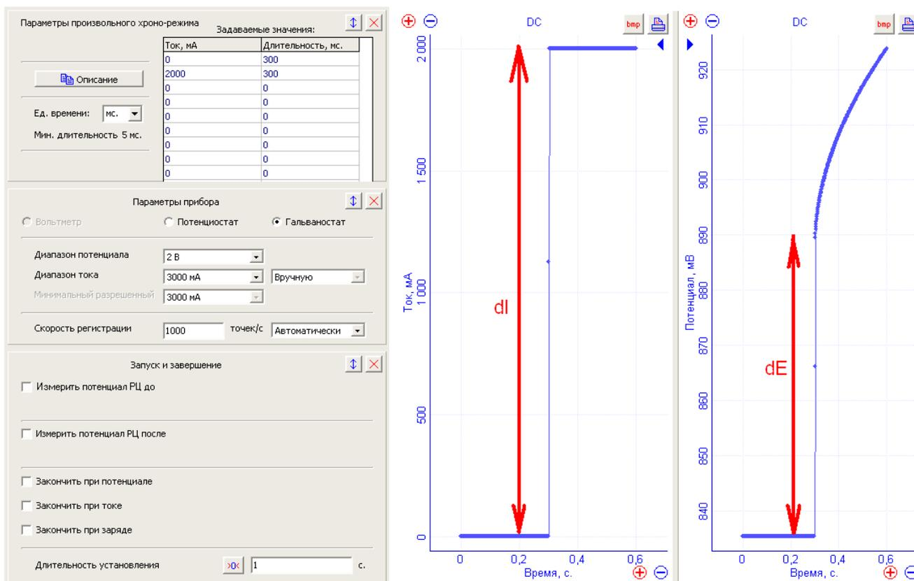
Рис.20. Параметры эксперимента по импульсному методу измерения омического
