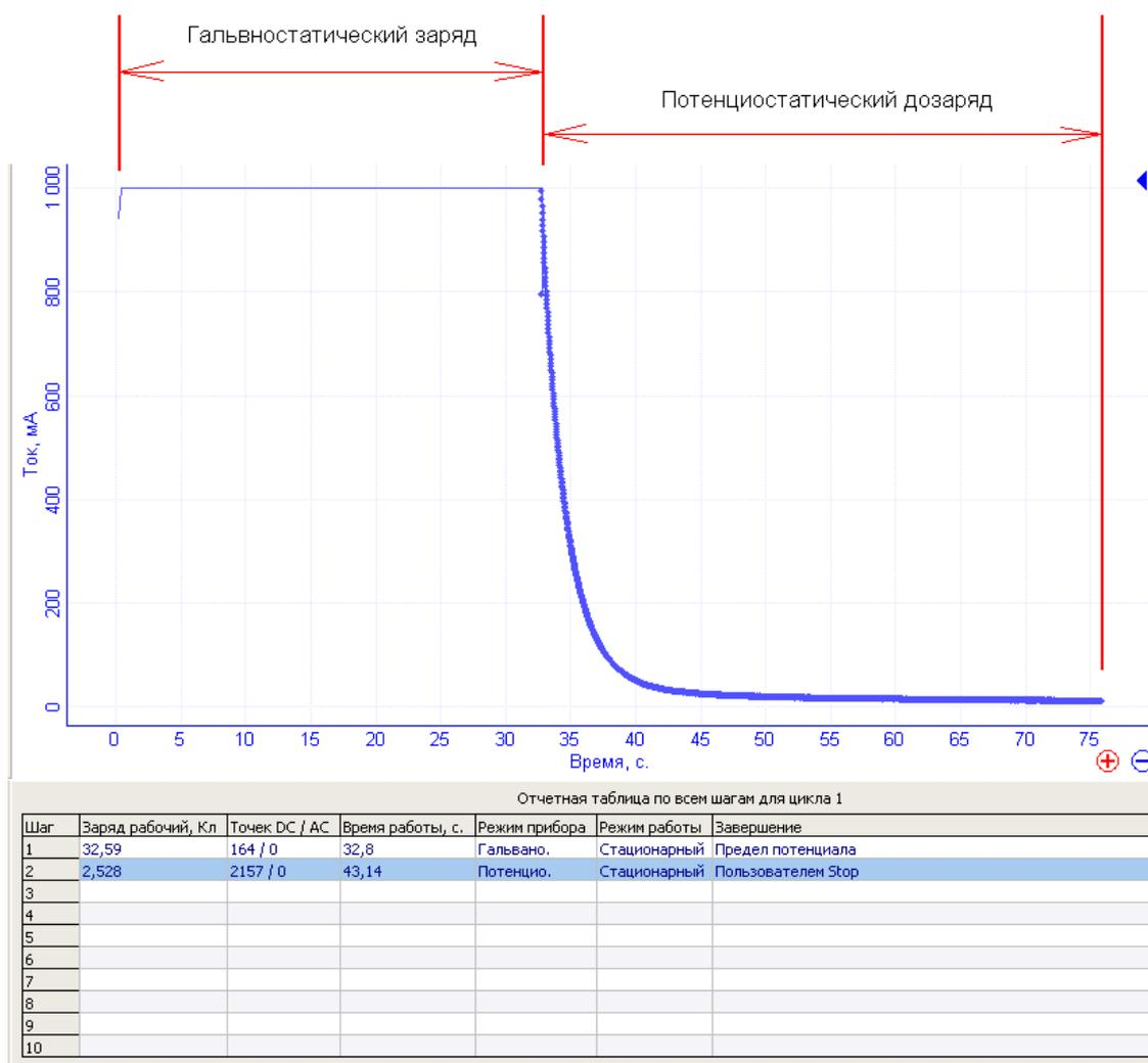
Рис. 14. Зависимость тока от времени в первых двух шагах циклирования ионистора, где первый шаг – традиционный гальваностатический заряд (здесь при постоянном токе 1 А до потенциала 1 В) с последующим дополнительным потенциостатическим дозарядом (здесь при потенциале 1В – равного пределу по потенциалу предыдущего гальваностатического заряда). Обратите внимание на отчетную таблицу под диаграммой – на заряды стадий – можно достичь дополнительной емкости почти в 10 процентов.
