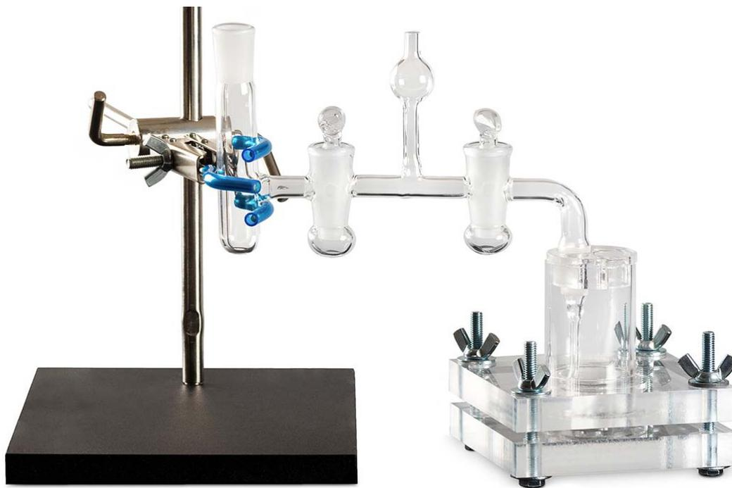
*Рис. 1. Опытный образец коррозионной ячейки с окном "Electrochemical Instruments" в сборе с двухкрановым мостиком электрода сравнения.*
