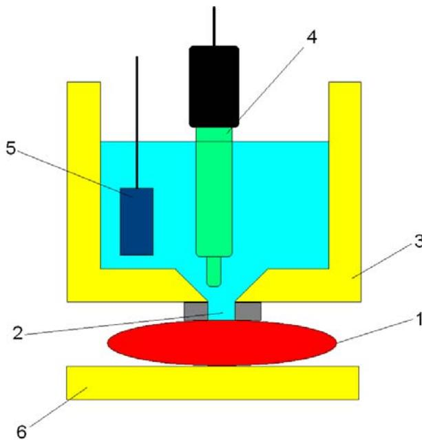
*Рис.2. Схема коррозионной ячейки с окном, в разрезе:*
