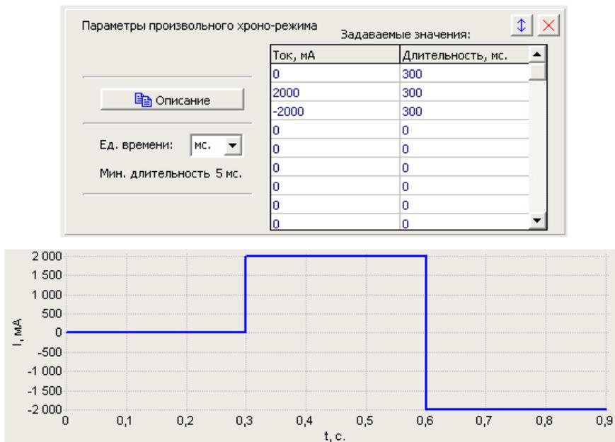
Рис. 22. Задаваемые обрабатываемые значения тока и получающаяся зависимость тока от времени при двойном перепаде тока в гальваностатическом измерении омического сопротивления.
