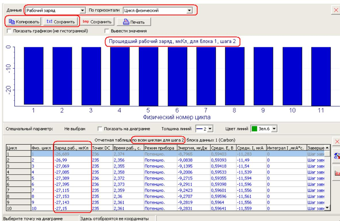
Рис.12. гистограмма и отчетная таблица для шага 2 (разрядного) линейной развертки потенциала, для программы из двух шагов – заряда и разряда стеклоуглеродного электрода. Красным выделено то, на что стоит обратить внимание: в таблице выведен суммарный заряд одного (здесь - второго) шага в зависимости от номера цикла, на гистограмме - то же, а отображенные на гистограмме данные можно скопировать или сохранить для дальнейшей обработки.
