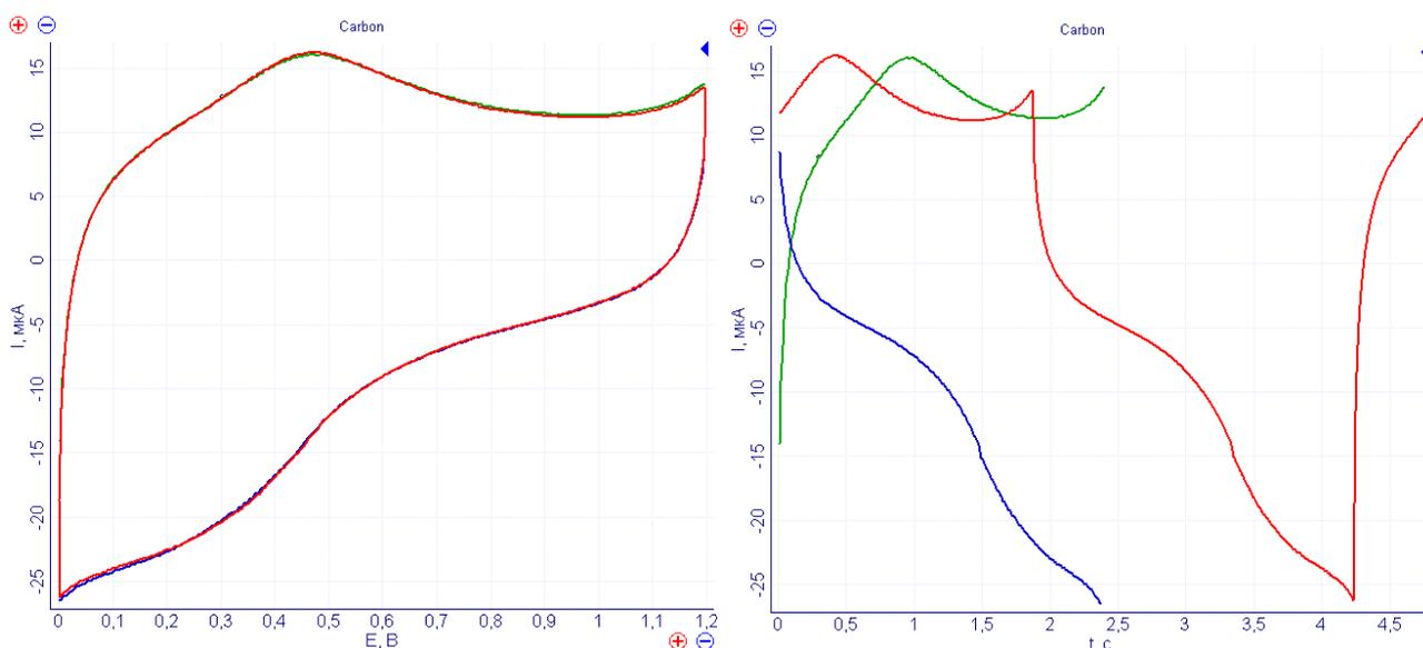
Рис. 11. Циклическая вольтамперограмма - синий цвет, и два шага линейной развертки: зарядный ход – зеленый, разрядный ход – синий. Два примера зарядно-разрядных экспериментов стеклоуглеродного электрода в 1М серной кислоте, скорость развертки 500 мВ/с. Слева в координатах  $I(E)$ , справа в  $I(t)$ . Времена в шагах начинаются с нуля.
