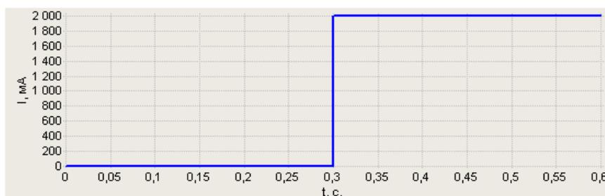
Рис. 21. Задаваемые обрабатываемые значения тока и получающаяся зависимость тока от времени при одиночном перепаде тока в гальваностатическом измерении омического сопротивления.
