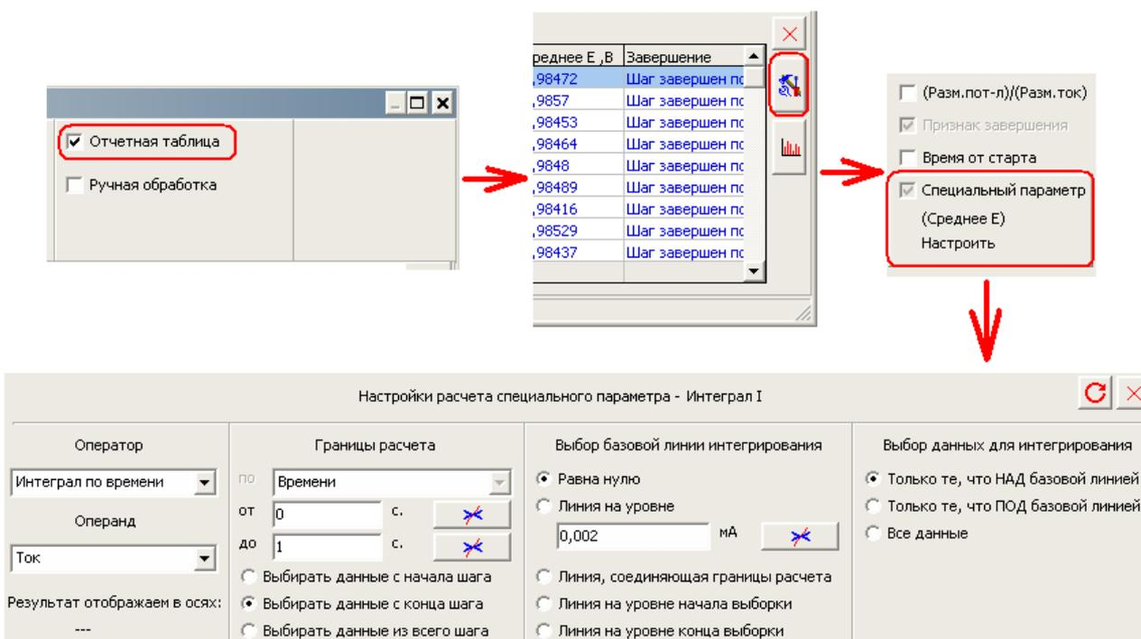
Рис.25. Открытие панели настройки расчета специального параметра отчетной таблицы режима обработки данных программы ES8, а также внешний вид этой панели.
