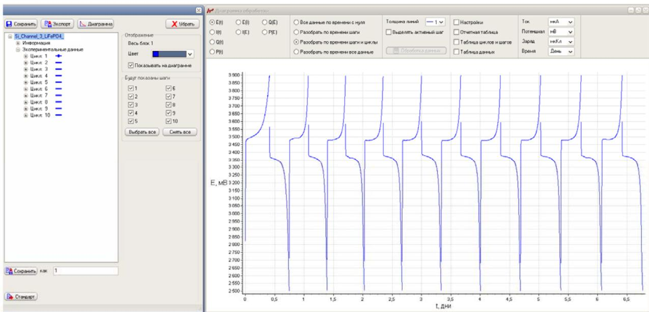
Пример длительного циклирования суперконденсаторной ячейки:
