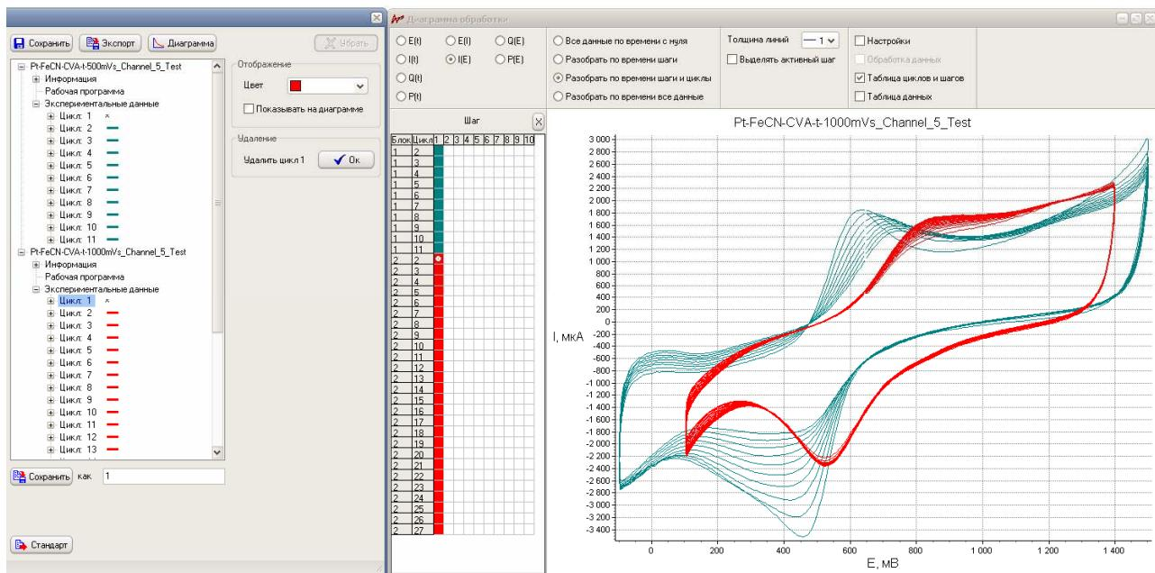
Два эксперимента. Два различных платиновых рабочих электрода, серная кислота 1М, хлорсеребряный электрод сравнения, Fe 2+, скорость развертки 800 мВ в секунду, несколько циклов для каждого блока данных:
