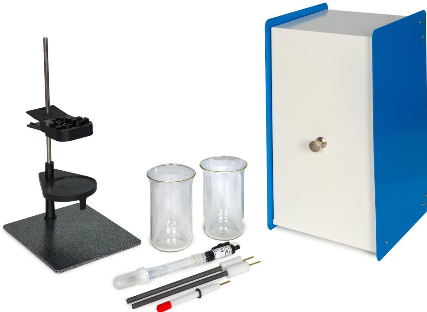
Рис. 1. Компоненты стартового комплекта №1: штатив ШУ-05, химические стаканы, электрод сравнения, вспомогательные электроды, рабочий электрод, экранирующий шкаф Ш-2М.
