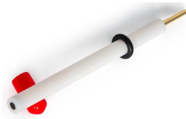
Рис. 3. Внешний вид рабочего стеклоуглеродного электрода со снятым защитным колпачком (красного цвета). Рабочая поверхность – диск черного цвета в торце электрода.
