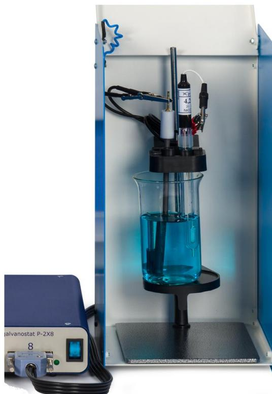
Рис. 5. Пример размещения потенциостата и собранной установки на основе комплекта №1.
