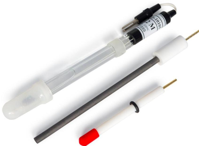
Рис. 2. Электроды из комплектации: электрод сравнения типа ЭСР-10101-4.2М; Графитовый вспомогательный электрод; рабочий стеклоглеродый электрод.
