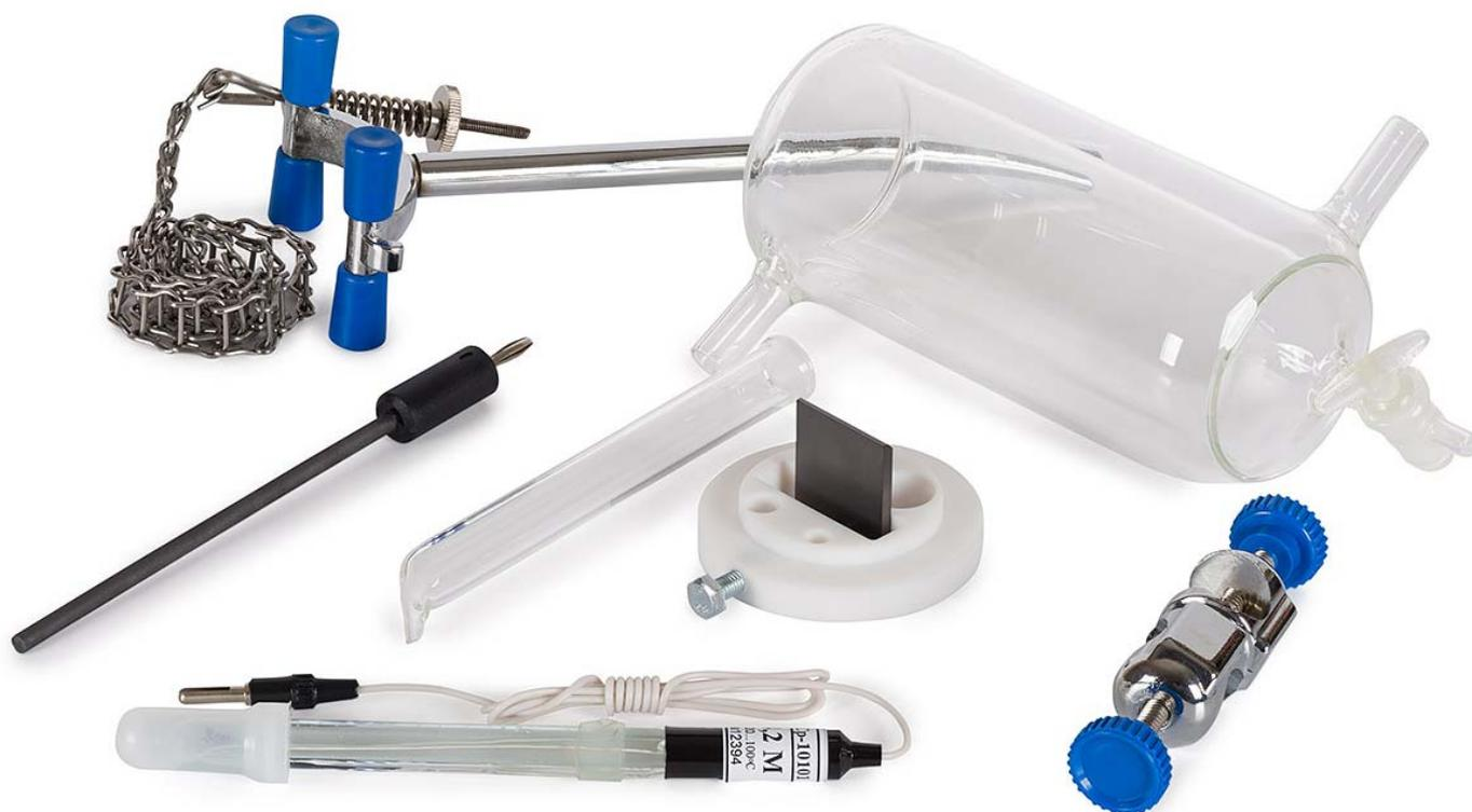
Рис. 1. Внешний вид основных компонентов ячейки по отдельности (рабочий электрод в комплект не входит и показан только в качестве примера установки его в рабочее положение).
