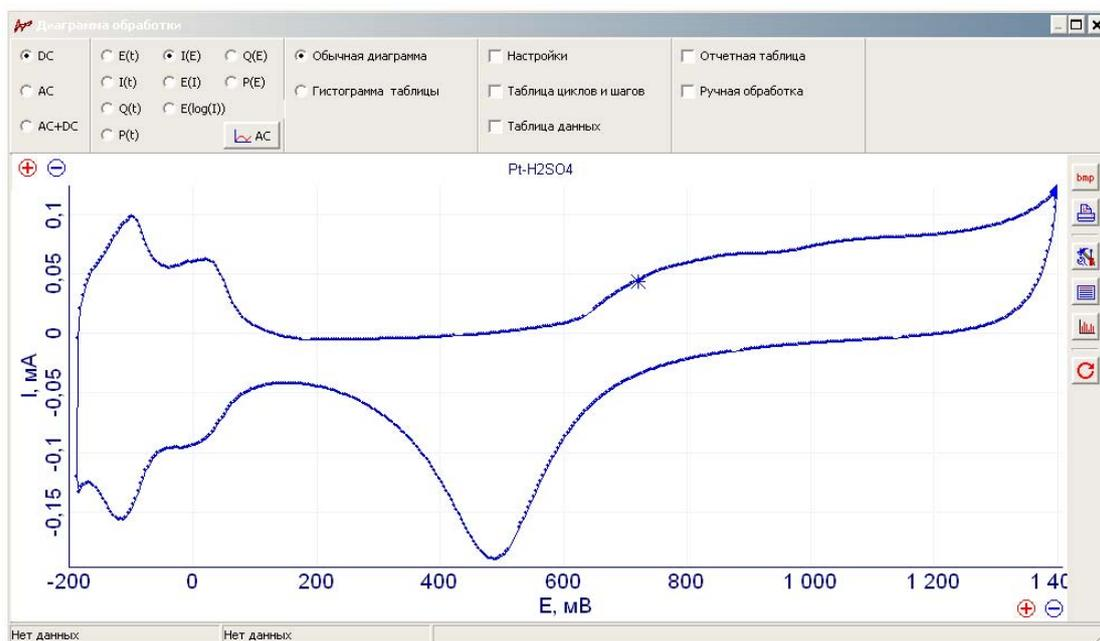
В самом простом виде окно диаграммы обработки выглядит, как на рисунке выше. Диаграмма служит для графического отображения выбранных пользователем экспериментальных данных. С помощью окна навигатора (дерева данных в нем) Вы можете выбрать какие данные – шаги и циклы отображать или нет, а также выбрать для них цвет отображения. Также существуют другие способы включения – выключения отображения на диаграмме, их мы рассмотрим далее - в своих разделах (в таблице шагов и циклов данных).
