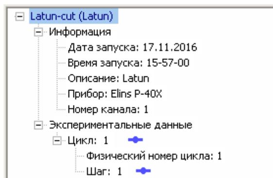
Дерево открытых данных представляет собой иерархическую структуру, в которой содержатся не только экспериментальные данные, рассортированные по шагам и циклам данных, но также и информацию об эксперименте – дату запуска, время запуска, комментарий, тип прибора и номер канала, если их несколько. Обычно дополнительная информация требуется только при восстановлении и поиске экспериментальных данных, если вдруг произошла их потеря или данные перепутались.
