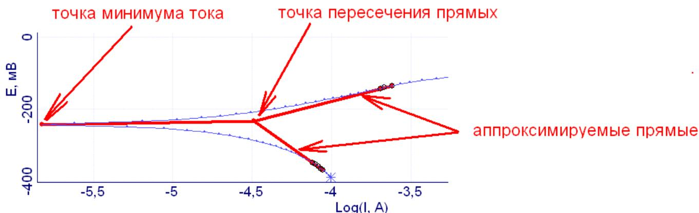
На диаграмме отображены две аппроксимируемые прямые, наклон которых и точку пересечения нужно рассчитать. Эти прямые пересекаются в одной точке, из которой можно узнать, например, ток коррозии в случае коррозионного эксперимента.
