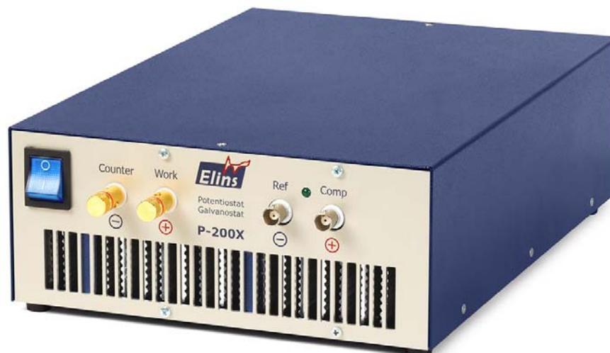
Мощный потенциостат-гальваностат P-200X разрабатывался специально для работы как с различными типами ХИТ и их батареями, так и с их компонентами, например, в жидкостной полуячейке. Он позволяет производить как разряд, так и заряд ХИТ токами до 15А, а также регистрацию вольтамперных кривых в стационарных режимах и путем линейной и циклической развертки тока или потенциала.
