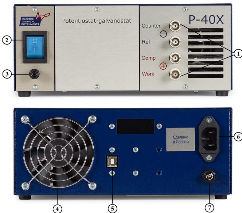
Рис. 2. Потенциостат-гальваностат P-40X, передняя и задняя панели:
