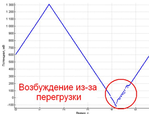
Циклические вольтамперограммы платины в 1N серной кислоте при автоматическом диапазоне тока. Эл. Сравнения насыщенный хлор-серебряный, раствор не продували, скорость развертки 500 мВ/с, скорость регистрации 100 течек в секунду. Выделены пустые промежутки, которые образовались в моменты переключения диапазонов тока, это нормальное явление для такой скорости развертки и скорости регистрации (при более низких скоростях развертки и регистрации они были бы менее заметны):
