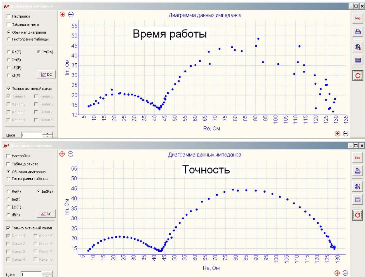
Модельная RC-цепь, 4 сборки конденсаторов и резисторов. 500 КГц – 7 мГц, амплитуда 200 мВ, настройка на время работы:
