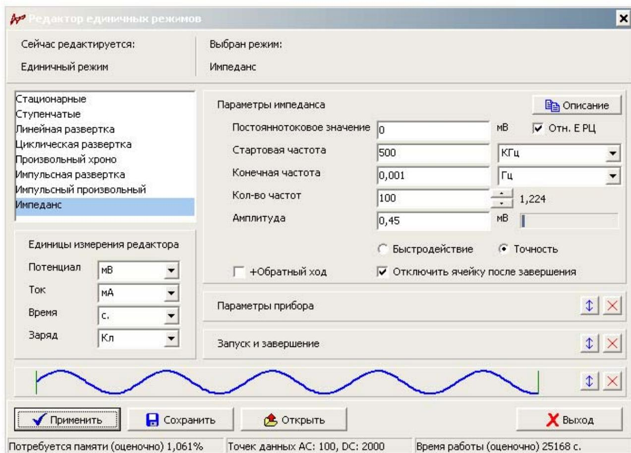
Режим измерения электрохимического импеданса, в своей основе, построен на стационарном потенциостатическом/гальваностатическом режиме работы, и поэтому унаследовал от него все настройки прибора и критерии остановки и запуска эксперимента. То есть, в процессе измерения импеданса прибор может:
