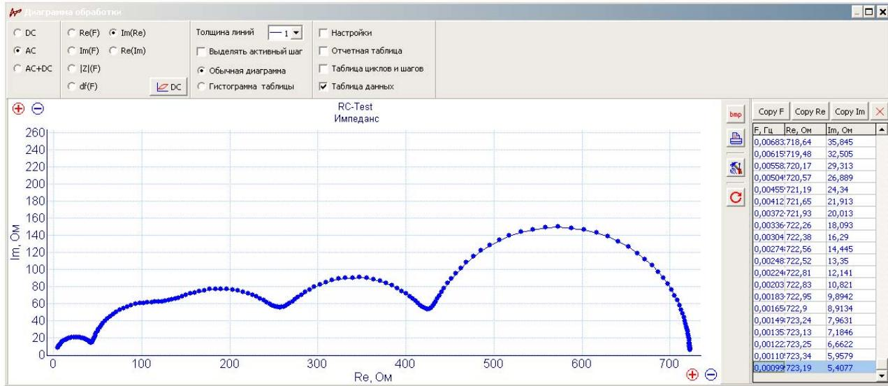
Модельная RC-цепь, 5 сборок конденсаторов и резисторов. 500 КГц – 1 мГц (полный частотный диапазон прибора), амплитуда 450 мВ, настройка на точность:
