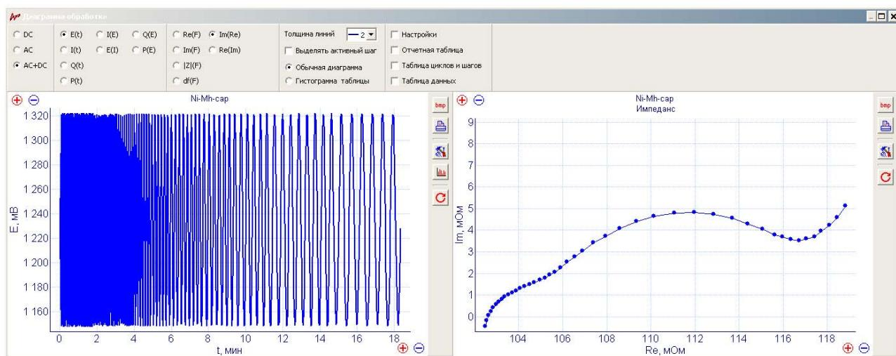
Li-батарея, 10 спектров в одном режиме программатора при различных сдвигах нагрузочного потенциала относительно потенциала РЦ. 300 КГц – 0,5 Гц:
