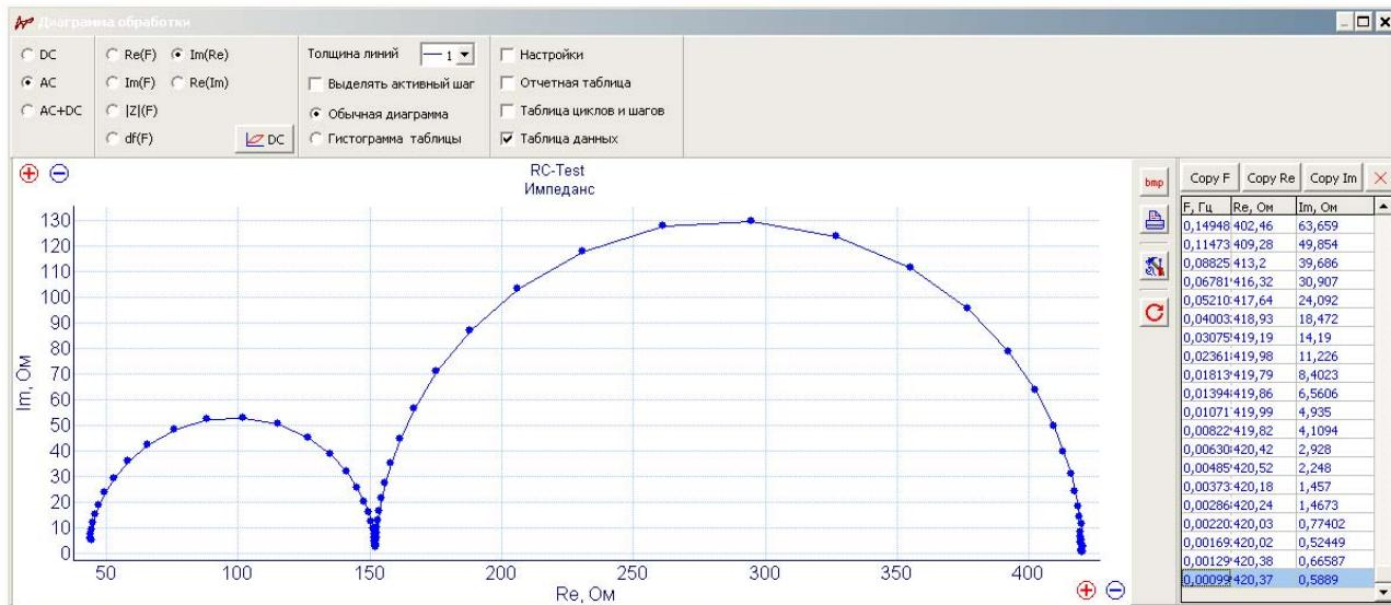
Модельная высокоомная RC - цепь, симуляция электролита - резистор 100 КОм, одного электрода - резистор 16.5 МОм параллельно конденсатором с 600 пФ, симуляция второго – блокирующего электрода – последовательно со всей сборкой конденсатор 6800 пФ. **Амплитуда 10 мВ.** Применены различные условия – с экранированием и без него, а также с настройками на время работы, и на точность.
