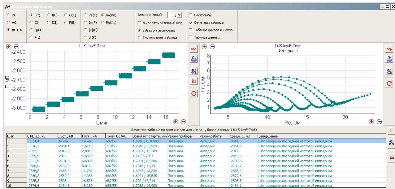
Li-батарея, 4 спектра в одном режиме программатора при различных сдвигах нагрузочного потенциала относительно потенциала РЦ. 300 КГц – 10 мГц ( обратите внимание на значение I уст – тока установления в отчетной таблице – это есть стационарное значение нагрузочного тока для приведенных экспериментов):
