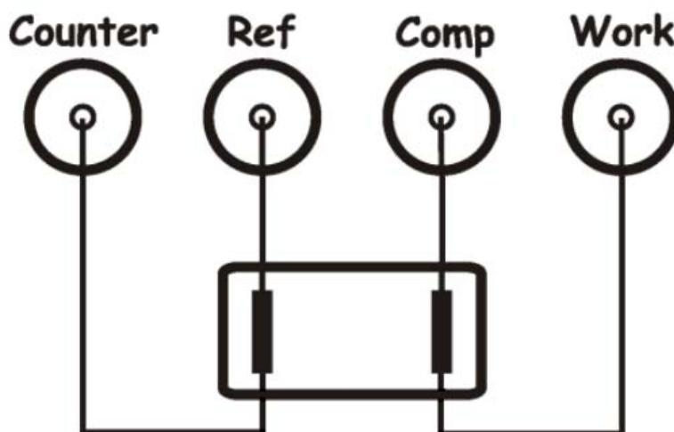
В четырехточечном подключении потенциальные провода компенсируют сопротивление (и импеданс) не только самих токовых проводов, но и сопротивление контактов подключения токовых электродов к исследуемому образцу.
