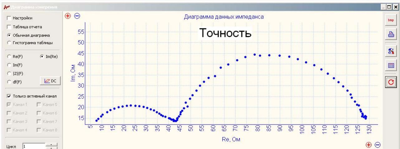
Модельная RC-цепь, 4 сборки конденсаторов и резисторов. 500 КГц – 7 мГц, амплитуда 200 мВ, настройка на время работы:
