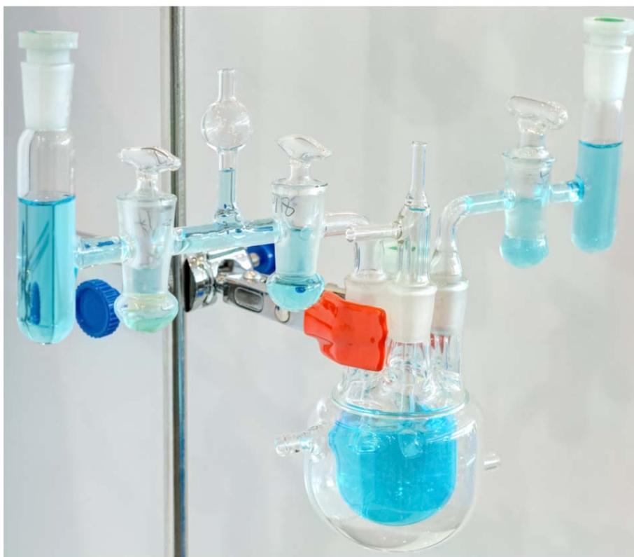
Рис.2. Внешний вид ячейки в сборе, заполненной раствором.
