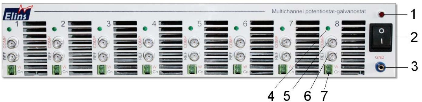
Рис. 2. Потенциостат-гальваностат P-20X8, передняя панель:
