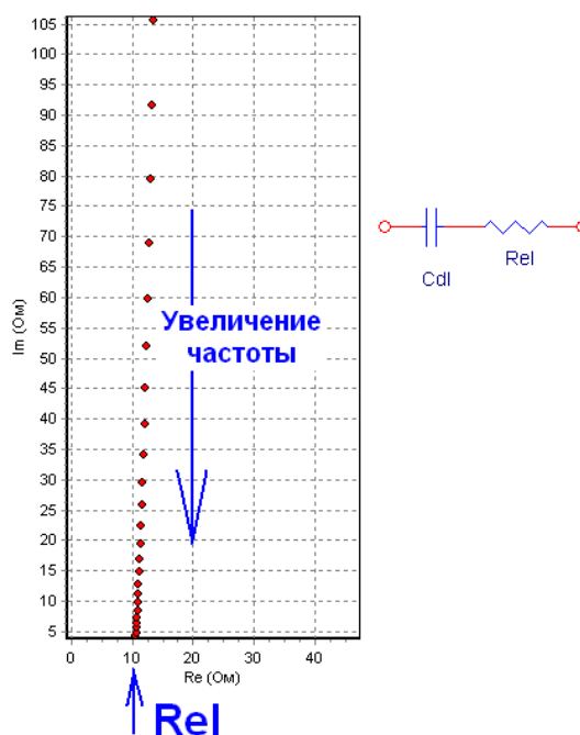
Рис. 5. Годограф импеданса и эквивалентная схема... Rel = 10 \text{ Ом} , Cdl = 0.12 \text{ мкФ} .
