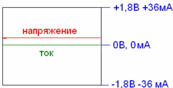
Рис.6. свойства оциллографической диаграммы на примере прибора Z-500P при выборе диапазона ток сопротивление 10-100 Ом.
