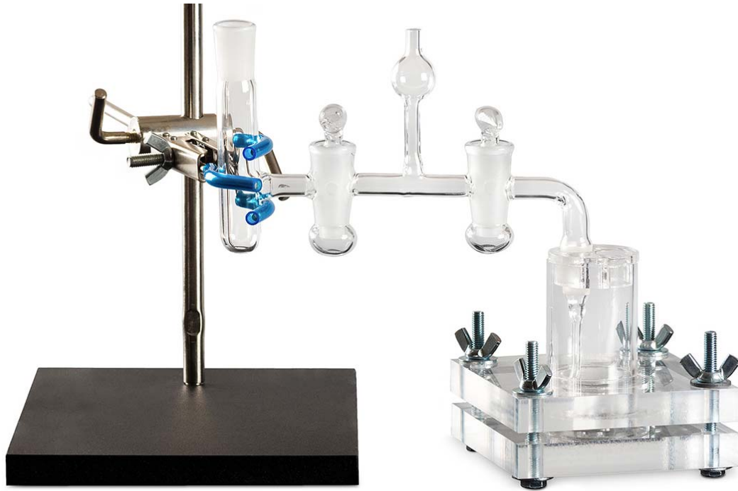
Рис. 1. Опытный образец коррозионной ячейки с окном ООО Элинс в сборе с двухкрановым мостиком электрода сравнения.
