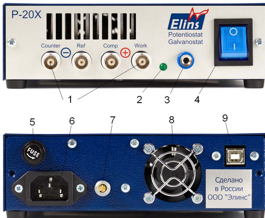
Рис. 2. Потенциостат-гальваностат P-20X, передняя и задняя панели:
