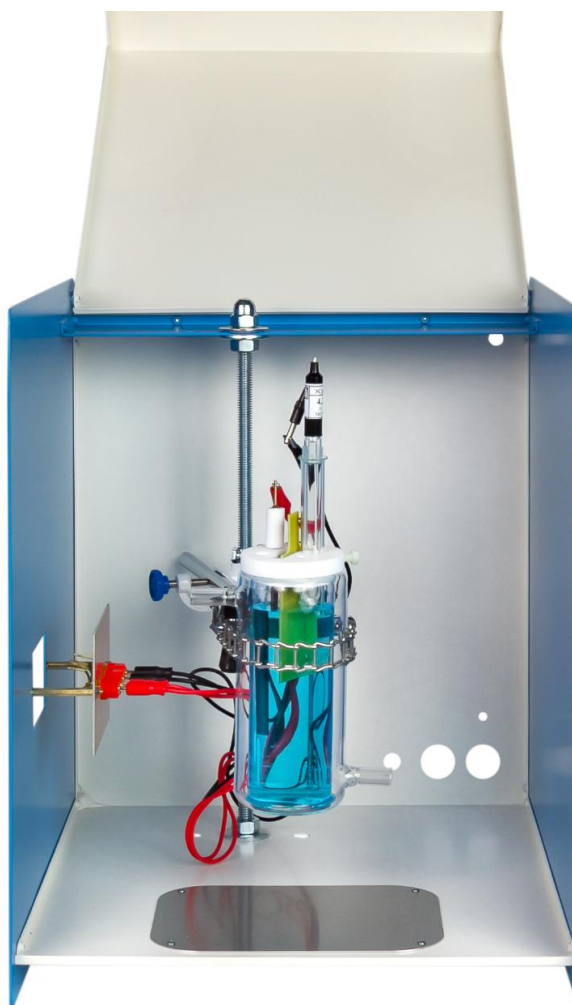
Рис. 2. Пример размещения электрохимической ячейки внутри шкафа.
