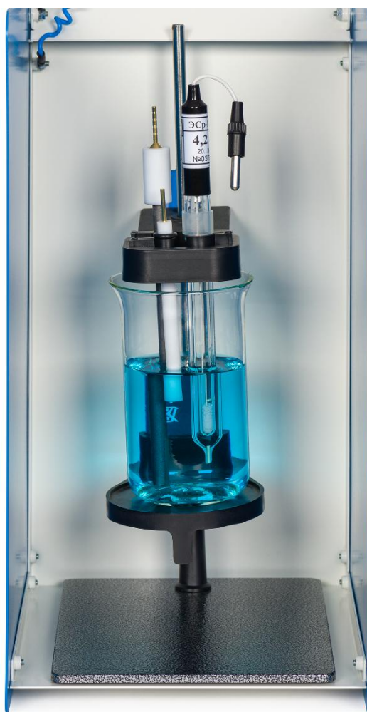
Рис. 2. Пример размещения штатива ШУ-1 внутри экранирующего шкафа Ш-2М вместе с простой электрохимической ячейкой на основе химического стакана и трех электродов.
