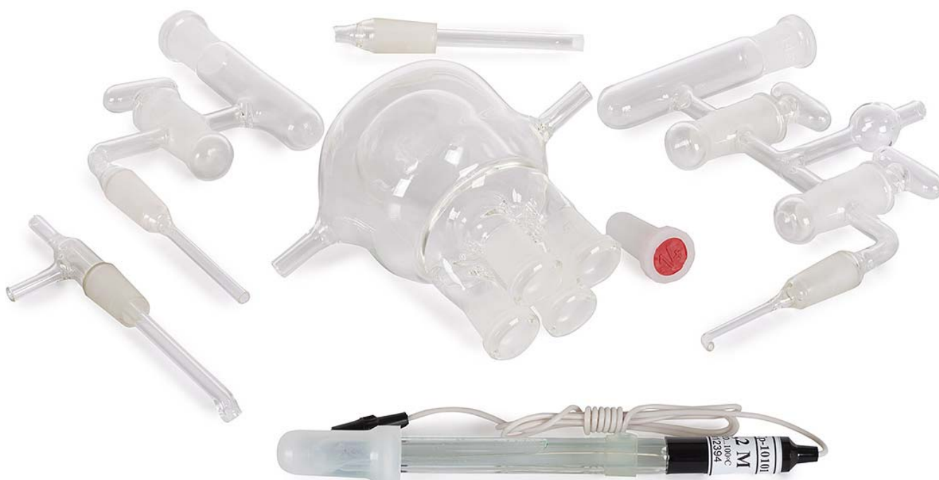
Рис.1. Внешний вид компонентов ячейки по отдельности.
