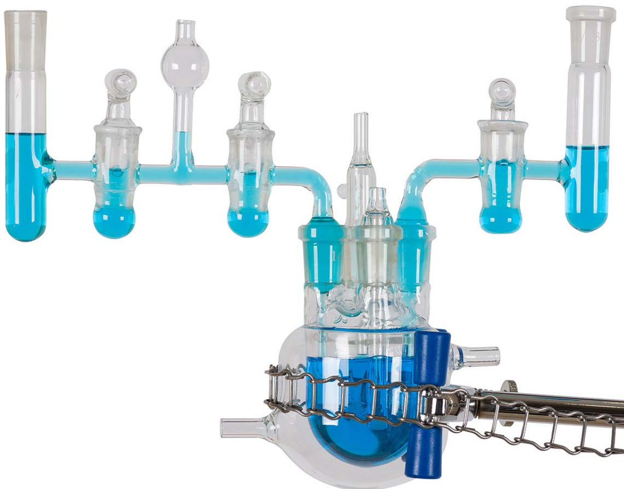
Рис.2. Внешний вид ячейки в сборе, заполненной раствором.
